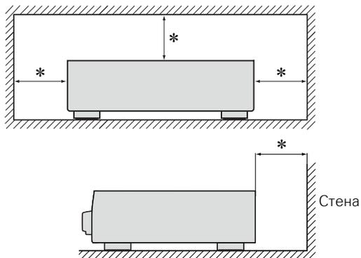
**\* Чтобы не препятствовать отводу тепла, не устанавливайте блок в закрытое ограниченное пространство, например, в книжный шкаф и т.п.**
