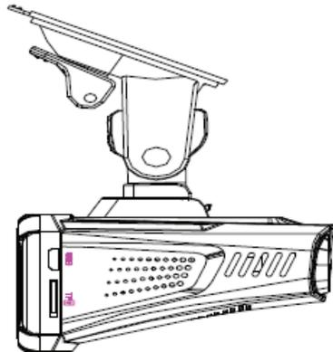
1. Вставьте в прибор карту памяти TF(Micro SD) класса 10 или выше емкостью до 128 Гб. Присоедините к прибору держатель. Подготовьте присоску держателя к монтажу на стекло, опустив рычажок.
