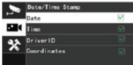
Выберите информацию, которая должна отображаться в отметке на изображении: дата, время, номер водительского удостоверения, координаты. Информация будет отображаться, если напротив установлена галочка.
