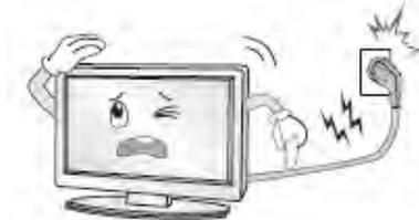
Не допускайте перегибание и зажим кабеля питания, особенно в местах выхода кабеля из телевизора и соединения кабеля с вилкой.
