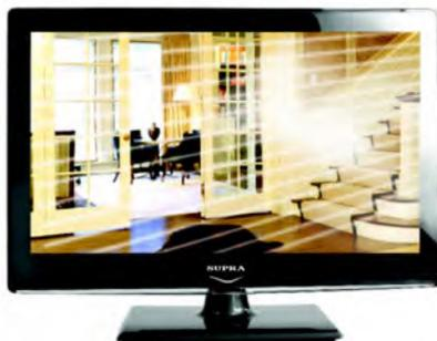
**ДИАГОНАЛЬНЫЕ ПОЛОСЫ И «ЕЛОЧКИ» НА ИЗОБРАЖЕНИИ, ЧАСТЬ ИЗОБРАЖЕНИЯ ОТСУТСТВУЕТ.** Обычно это вызвано использованием рядом с телевизором электротермического оборудования (в больнице).
