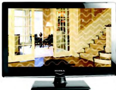
**ИЗОБРАЖЕНИЕ С КРИВЫМИ ЛИНИЯМИ И ДРОЖИТ.** Обычно это вызвано электромагнитным излучением работающих вблизи приборов (фенов, мобильных телефонов, радиоприемников или радиопередатчиков).
