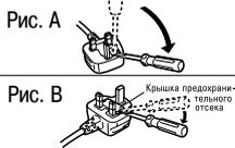
2. Замените плавкий предохранитель и закройте или прикрепите крышку отсека.
