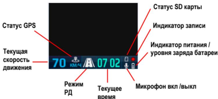
По умолчанию в устройстве установлен режим дисплея РД+ВР (радар-детектор и видеорегистратор). В этом режиме на дисплей выводится изображение с камеры видеорегистратора, на которое накладывается информация от GPS радар-детектора. В режиме дисплея РД изображение с камеры видеорегистратора не выводится, но запись видео осуществляется. На дисплее отображается текущая скорость и направление движения, а также информация оповещения от GPS радар-детектора.
