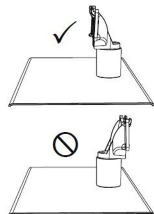
Совместите поворотный механизм (A) с основанием настольной подставки (B). Шип (Y) должен размещаться в соответствующем отверстии на основании.
