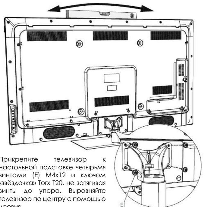
Прикрепите телевизор к настольной подставке четырьмя винтами (E) M4x12 и ключом «звёздочка» Torx T20, не затягивая винты до упора. Выровняйте телевизор по центру с помощью уровня.
