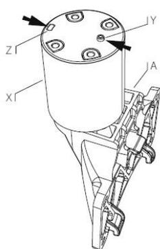
Проверьте, правильно ли расположен кожух (X) поворотного механизма (A). Сборку можно продолжить, если шип (Y) и отверстие (Z) расположены так же, как показано на прилагаемом рисунке.
