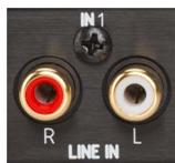
1. **Несимметричный вход (стерео), RCA:** стандартный вход для сигналов от всех источников из категории бытовой электронной аппаратуры (CD-проигрыватели, тюнеры, линейный выход телевизоров и пр.), которые снабжены аналоговым выходом. Подключите источник к этим разъёмам, например, с помощью кабеля RCA из комплекта поставки («I», см. стр. 2). Чтобы выбрать этот вход, нажмите кнопку «1» на пульте ДУ.
