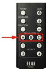
Используйте кнопки «A», «B» и «C» из группы «TRANSMITTER ID» пульта ДУ (нажмите и удерживайте дольше 1 секунды!) для сопряжения акустической системы и конкретного передатчика. В случае использования простой стереосистемы позаботьтесь, чтобы база AIR-X была настроена на ID «A».
