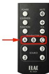
*Установите тот же канал на каждой акустической системе с помощью пульта ДУ. Нажмите на соответствующую кнопку на пульте и удерживайте её нажатой не менее четырёх секунд*
