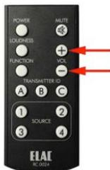
Пульт ДУ можно использовать для регулировки уровня громкости («VOLUME») акустической системы. Если несколько акустических систем подключены по беспроводному каналу, то изменение громкости одной из них также приводит к изменению уровня громкости других АС. Базовая настройка громкости при первом включении акустической системы: -6 дБ.
