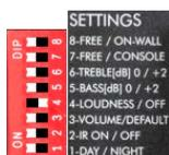
9. **Переключатели для выбора предустановок:** семь переключателей для регулировки звука в соответствии с личными предпочтениями и для особых ситуаций настройки. Предусмотрен переключатель для регулировки яркости светодиода на передней панели. Примеры применения смотрите на стр. 15 и далее.
