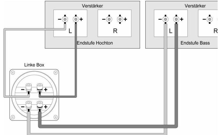
Одна пара присоединительных клемм ведет к ВЧ и СЧ динамикам, другая к НЧ динамикам. Посредством раздельного прохождения напряжения (Bi-Wiring) достигается расстыковка обеих ветвей, т.е. наложение между низкими и средними/высокими частотами снижается. Для этих же целей применяются оптимизированные присоединительные кабели, например, низкоиндуктивные кабели для высоких частот, и кабели с большими диаметрами для низких.
