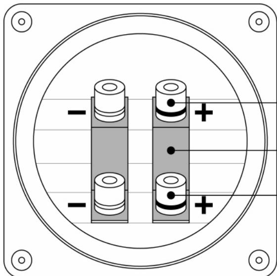
Многие из наших АС дают возможность проигрывать средние и высокие тона отдельно от басов (Bi-Amping) через два усилителя, или как минимум посредством отдельный присоединительных кабелей (Bi-Wiring). Данные АС оснащены двумя парами входных клемм. Две пары присоединительных клемм связаны закорачивающей перемычкой для обеспечение нормальной эксплуатации (с одним подводящим кабелем).
