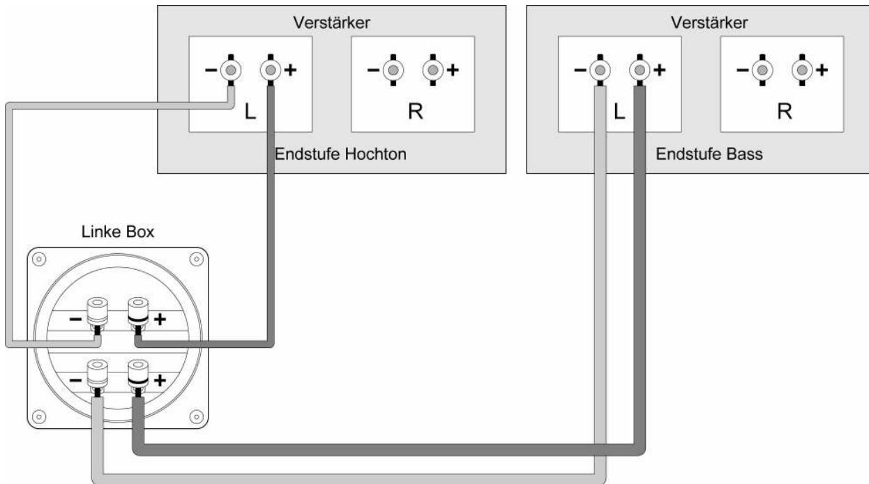
Если же обе ветки эксплуатируются посредством раздельных конечных усилителей, становится возможным выбрать подходящий усилитель для передачи высоких, средних или же низких частот. С раздельной регулировкой громкости для обеих ветвей общий баланс звучания легче приспособить к местным заданным условиям (акустике помещения).
