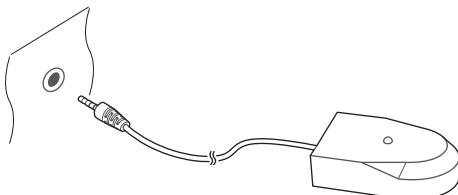
Подключите удлинитель пульта ДУ к разъему IR Rec. ресивера. Удлинитель не должен быть направлен на источник света, такой как лампа или монитор. В противном случае это может помешать передаче инфракрасного сигнала.
