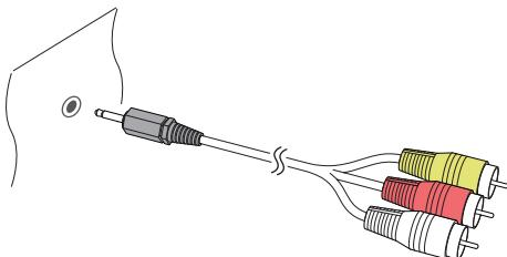
Вставьте штекер кабеля RCA в разъем A/V OUT ресивера, а затем подключите штекеры RCA на другом конце кабеля к композитным аудио-видео входам телевизора. Следите за цветами штекеров и разъемов — они должны совпадать.
