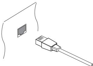
Соедините порт LAN ресивера с разъемом маршрутизатора с помощью сетевого кабеля. Настройка параметров сети описана в разделе Параметры сети на стр. 44.
