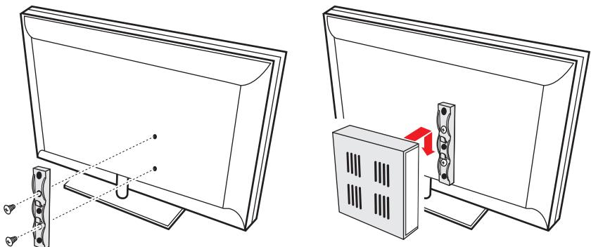
Для экономии места вы можете установить ресивер непосредственно на телевизор. Зафиксируйте кронштейн на задней поверхности телевизора, а затем закрепите на нем ТВ-ресивер, как показано на рисунке выше.
