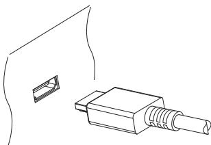
Соедините разъемы HDMI ресивера и телевизора кабелем HDMI.
