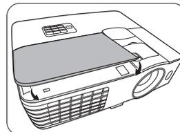
11. Затяните винт крепления крышки лампы.
