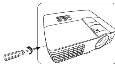
3. Снимите крышку лампы с проектора.
