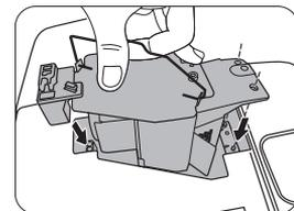
8. Затяните винт крепления лампы.
