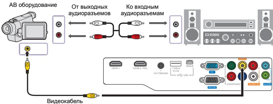
Если после включения проектора и выбора соответствующего источника видеосигнала воспроизведение видео не происходит, проверьте включение и исправность источника видеосигнала.
