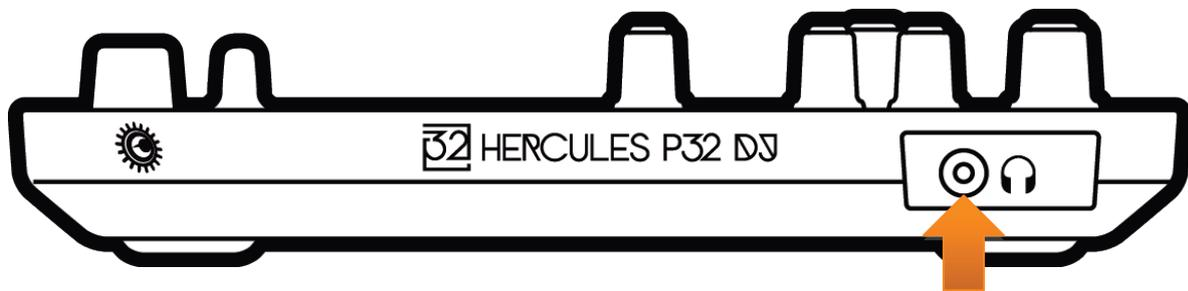
По умолчанию при каждом подключении устройства выход для наушников связывается с выходом 3 — 4 для обеспечения совместимости с любыми микшерными программами, доступными на рынке, в частности с программой DJUCED™ 40°.
