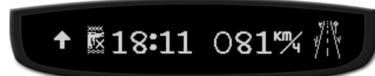
При обнаружении сигнала радара звуковой сигнал в зоне **Тихого режима** не подаётся, на дисплей вместе со скоростью выводится диапазон и уровень сигнала:
