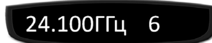
*На рисунке: Информация на дисплее при обнаружении радарного сигнала среднего уровня мощности, работающего в диапазоне К:*
