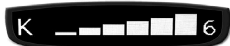
*На рисунке: Информация на дисплее, работающем в режиме отображения частоты, при обнаружении сильного сигнала радара на частоте 24.100 ГГц:*
