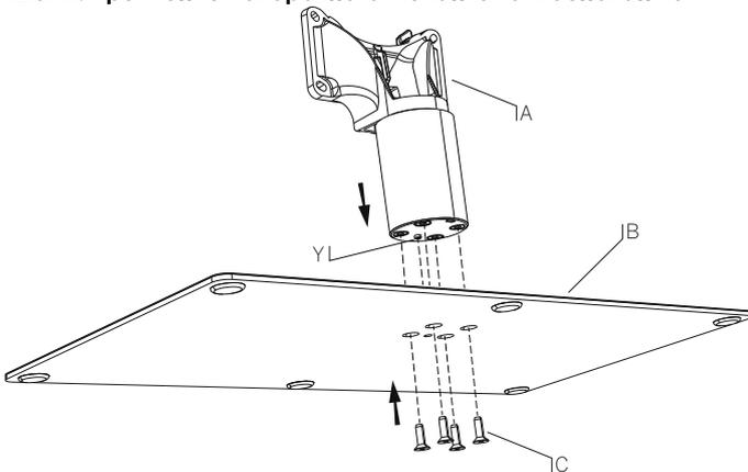
Совместите поворотный механизм (A) с основанием настольной подставки (B). Шип (Y) должен размещаться в соответствующем отверстии на основании.
