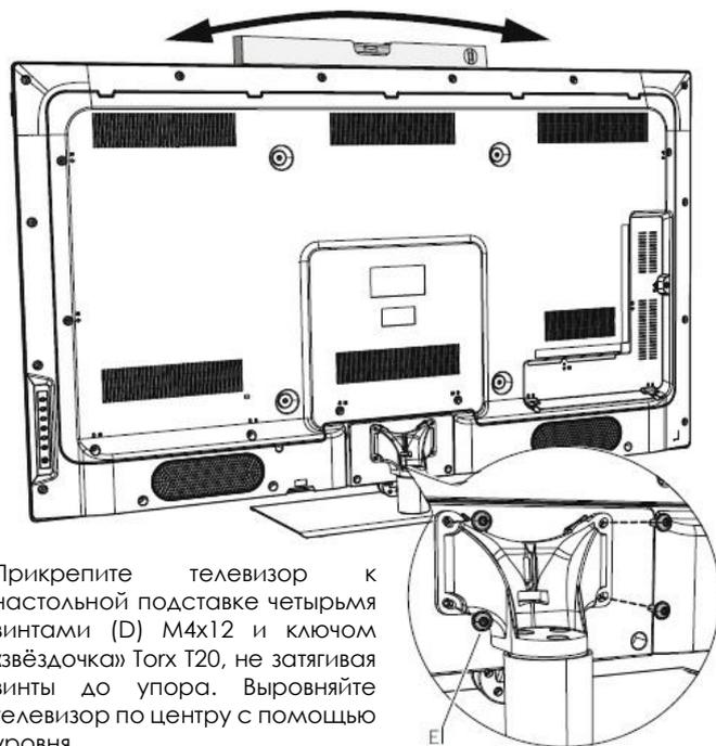
Прикрепите телевизор к настольной подставке четырьмя винтами (D) M4x12 и ключом «звёздочка» Torx T20, не затягивая винты до упора. Выровняйте телевизор по центру с помощью уровня.
