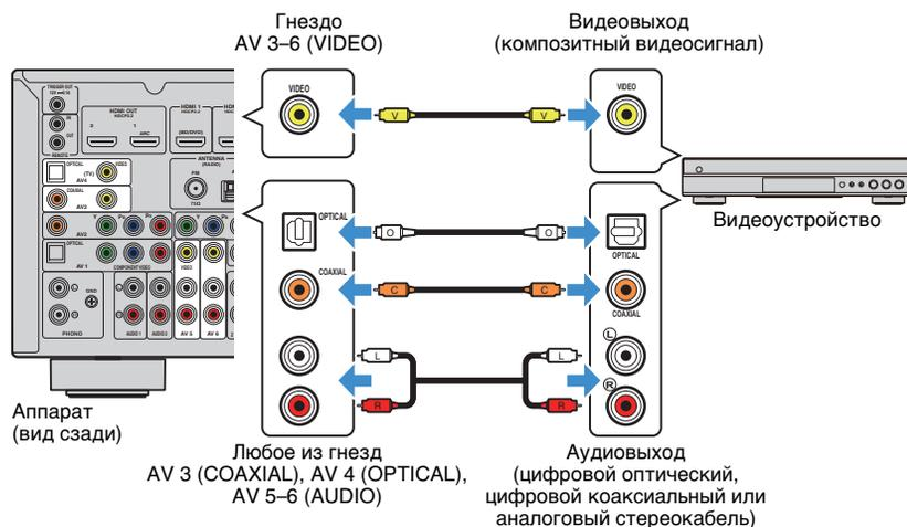
Если в качестве источника входного сигнала аппарата выбрать AV 3–6, видео/аудиосигнал, который воспроизводится на видеоустройстве, будет выводиться через аппарат.
