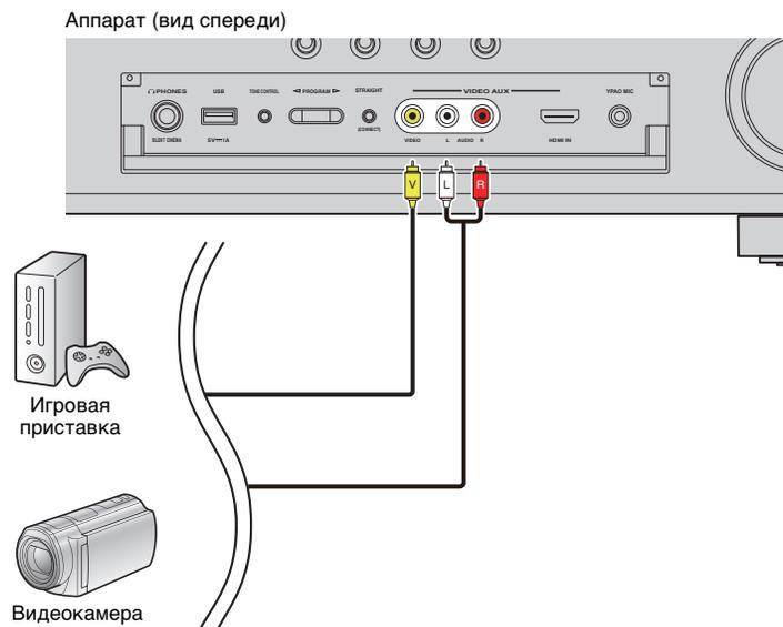
Если в качестве источника входного сигнала аппарата выбрать “V-AUX”, нажав кнопку V-AUX, видео- или аудиосигнал, который воспроизводится на устройстве, будет выводиться через аппарат.
