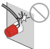
Если на дисплее передней панели появилась надпись “Check SP Wires”, когда аппарат включен, выключите аппарат и проверьте наличие короткого замыкания кабелей колонок.
