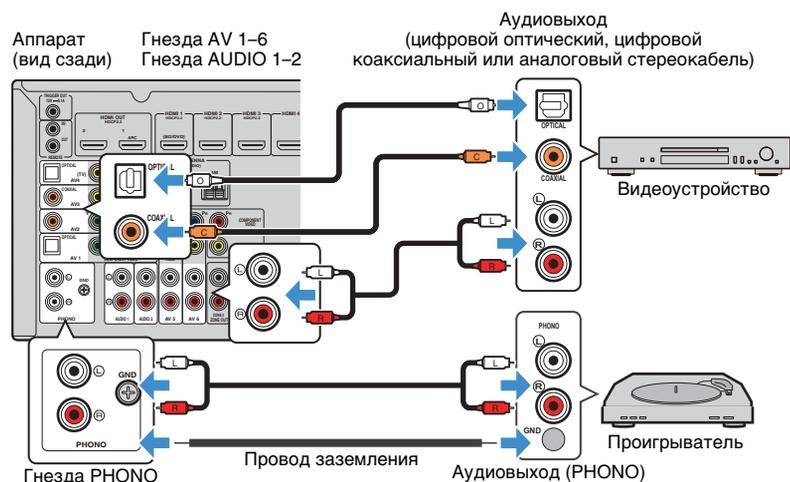
Если выбрать источник входного сигнала, нажав кнопки AV 1-6, AUDIO или PHONO, аудиосигнал, воспроизводимый аудиоустройством, будет выводиться через аппарат.
