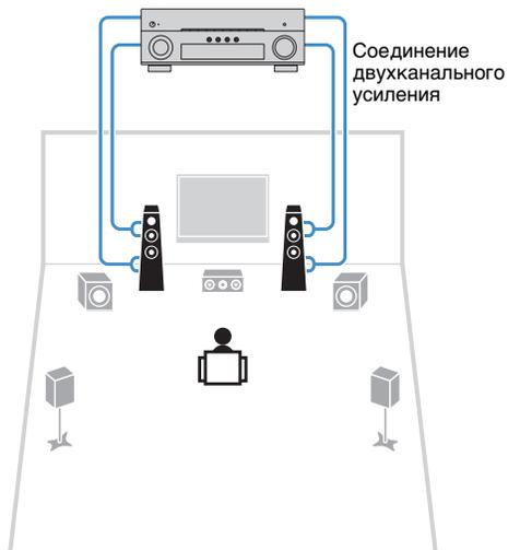
**Использование дополнительных внутренних усилителей для подключения стерео колонок из другой комнаты**
