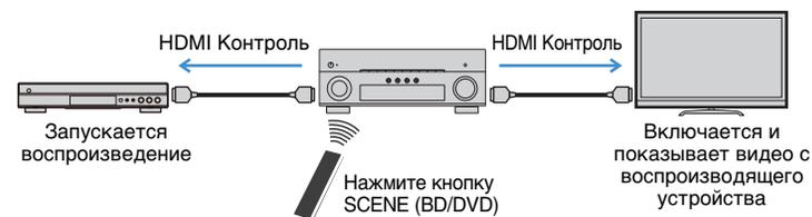
Для использования управления HDMI необходимо выполнить следующую настройку соединения HDMI Контроль после подключения телевизора и воспроизводящих устройств.
