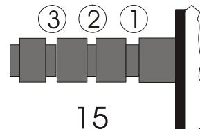
Перекиньте петлю подвески груза антискейтинга через канавку на направляющей (15), соответствующую прижимной силе, установленной для Вашего звукоснимателя, и пропустите нить через проволочную петлю суппорта (17).
