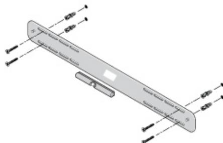
7. Закрепите кронштейн PLAYBAR на стене при помощи винтов, поставляемых в монтажном наборе. Используйте уровень для финальной проверки точности, и после этого затяните винты до конца.
