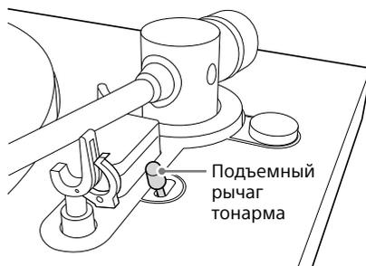
Для остановки воспроизведения до его завершения нажмите подъемный рычаг тонарма к задней стороне проигрывателя.
