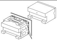
С помощью отвёртки или подобного инструмента отогните лапки монтажной коробки и установите её на место.
