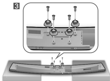
4. Вставьте **Винты для установки на стену** в 3 отверстия один за другим для закрепления **Кронштейн для крепления к стене** на стене.
