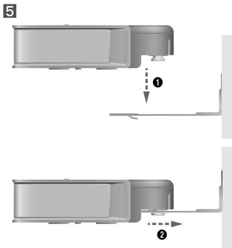
6. Зафиксируйте **Фиксатор опоры** (для фиксации настенного крепления), чтобы соединить **Кронштейн для крепления к стене** с системой Soundbar.
