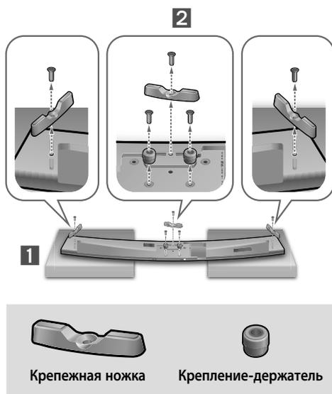
3. Закрепите **Держатель винта 1** (4 шт.) и **Держатель винта 2** (для крепления основного устройства) (4 шт.) крепко в отверстия системы Soundbar, как показано на рисунке.
