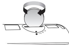
3. С помощью подходящей монетки поворачивайте крышку отсека для батарей в пульте дистанционной управления в направлении по часовой стрелке до тех пор, пока она не встанет на место.
