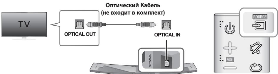
1. Подключите разъем **OPTICAL IN** (аудио) на системе Soundbar к разъему OPTICAL OUT на телевизоре.
