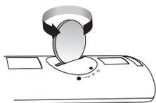
1. С помощью подходящей монетки поверните крышку отсека для батарей в пульте дистанционного управления против часовой стрелки и снимите ее, как показано на рисунке выше.
