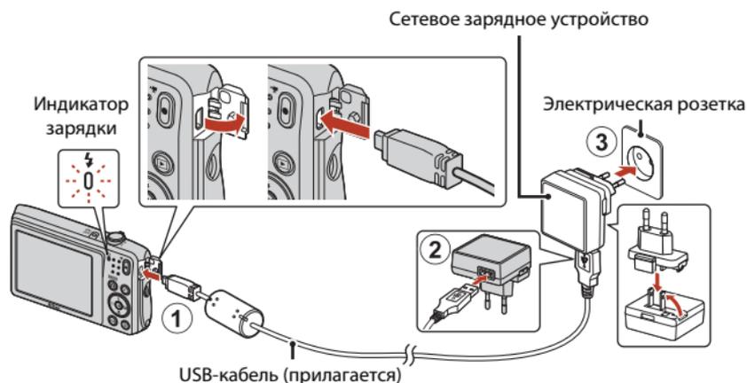
Если в комплект поставки фотокамеры входит сетевой переходник\*, надежно подсоедините его к сетевому зарядному устройству. После этого при попытке отсоединения сетевого переходника с усилием можно повредить изделие.
