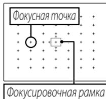
При создании композиции кадра по ЖК-монитору можно выбрать размер фокусирующей рамки. Нажмите кнопку **MENU/OK**, а затем в меню съемки выберите параметр **ЗОНА ФОКУСИРОВКИ**, после чего поверните диск выбора параметров. Размер рамки можно уменьшать на 50% и увеличивать на 150%. Настройка вступает в силу после повторного нажатия кнопки **MENU/OK**.
