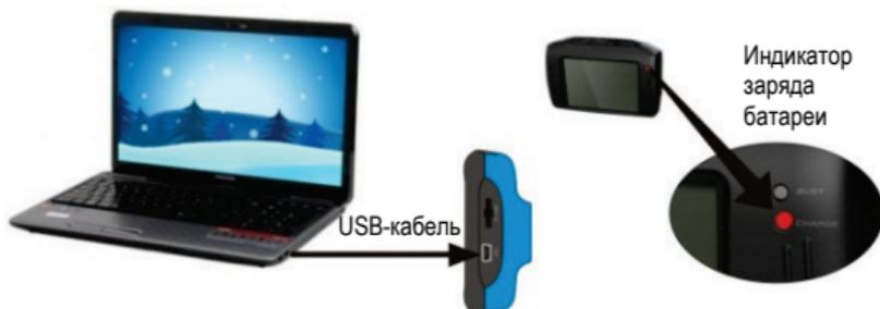
Соедините камеру с компьютером с помощью USB-кабеля. На камере загорится индикатор заряда, показывая, что зарядка батареи началась. Индикатор будет гореть во время всего цикла зарядки и погаснет после полной зарядки батареи. В среднем батарея полностью заряжается за 2-4 часа.
