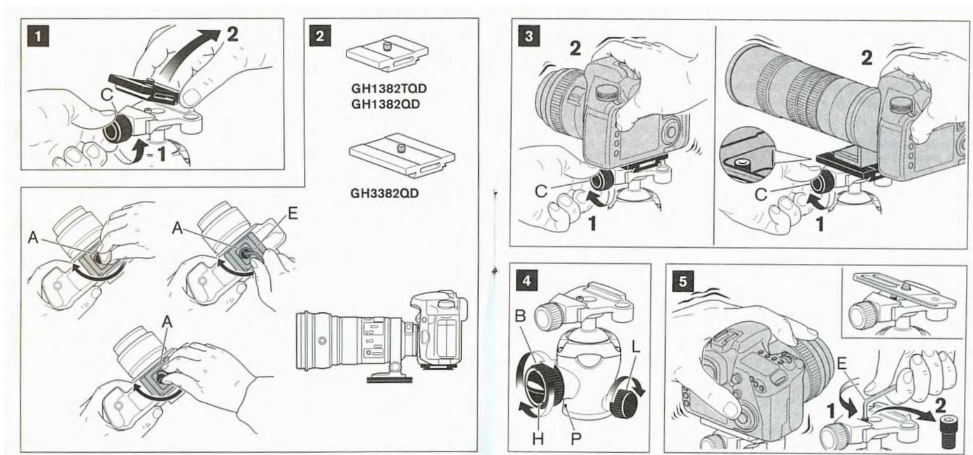
РИС. 1 — Как снять подкамерную площадку
