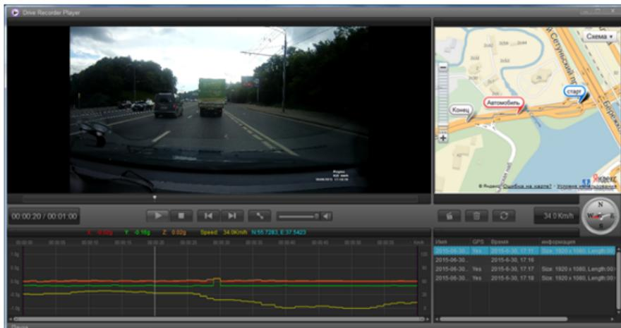
Устройство оснащено встроенным 3G-сенсором. Когда происходит существенное изменение по любой из осей X, Y, Z, устройством будут записаны защищенные файлы. Например, в случае столкновения с другим автомобилем. Анализ записи G-сенсора может помочь определить ответственного.
