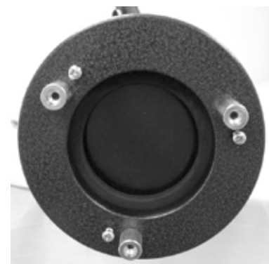
Рис. 5-2. PowerSeeker 114 EQ —оправа главного зеркала
