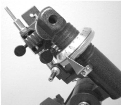
Рис. 2-24 Фиксатор оси склонения находится над координатным кругом склонений, фиксатор оси прямого восхождения находится над кругом прямого восхождения.
