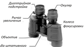
Бинокль на призмах с крышей (Roof)
