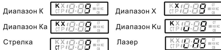
Цифры на дисплее показывают силу улавливаемого сигнала.
