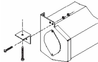
Для монтирования на плоской стене ниши с потолком используйте отверстия спереди монтажных кронштейнов.
