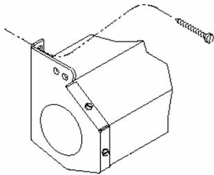
Для монтирования на плоской стене используйте отверстия сзади монтажных кронштейнов.
