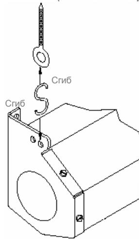
Для подвешивания используйте отверстия, имеющиеся спереди монтажных кронштейнов. Разметьте должным образом отверстия под винты или другие крепежи (не комплектуются) в потолочной балке или в другой твердой поверхности. Подвесьте S-образные крюки (не комплектуются) от зажимов и проденьте через отверстия спереди монтажных кронштейнов. Для повышения надежности согните оба конца S-крюков, таким образом, чтобы экран не смог соскочить.
