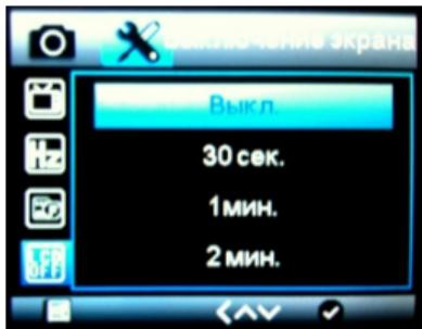
Подраздел “Задержка выключения” предназначена для автоматического выключения видеорегистратора через установленный промежуток времени (5, 10, 30 секунд) при отключении внешнего источника питания (выключении зажигания автомобиля).
