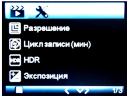
Подраздел “Разрешение” позволяет выбрать один из четырех значений качества видеозаписи - разрешение Full HD, HD, WVGA,VGA .
