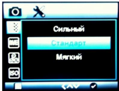
Подраздел "Баланс белого" позволяет выбрать режим освещения снимаемого объекта.
