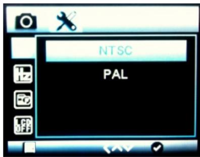
Подраздел “Частота” позволяет установить необходимую частоту (50 или 60 Гц).
