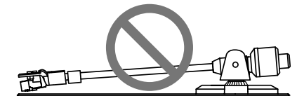
Contrapeso demasiado inclinado hacia la parte delantera
