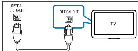
1 С помощью оптического кабеля подключите разъем **OPTICAL** этого устройства к оптическому выходу на телевизоре.
