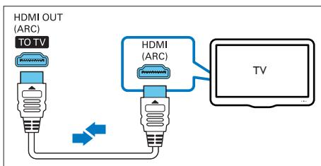
1 С помощью высокоскоростного кабеля HDMI подключите разъем **HDMI OUT (ARC)** на продукте к разъему **HDMI ARC** на телевизоре.
