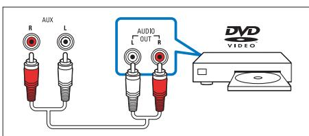
1 С помощью аналогового аудиокабеля подключите разъем **AUX** этого устройства к аналоговому аудиовыходу на внешнем устройстве.
