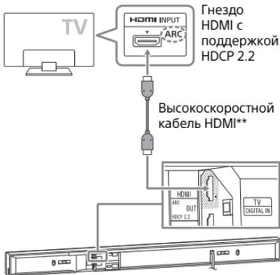
\* Функция ARC (Реверсивный звуковой канал) отправляет цифровой аудиосигнал от телевизора на данную систему с помощью одного лишь кабеля HDMI.
