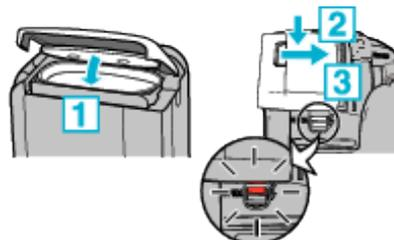
Крышка не закрыта должным образом, если видна красная отметка на замке крышки разъемов.
