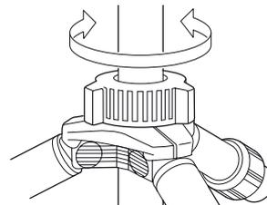
Чтобы поднять центральную колонну ослабьте блокиратор вращением против часовой стрелки и вытяните колонну на желаемую высоту. Затяните блокиратор вращением по часовой стрелке.
