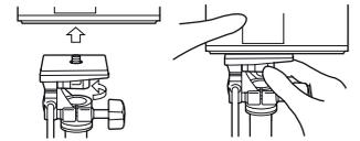
Совместите штативное гнездо камеры с винтом штатива и накрутите камеру против часовой стрелки до плотного соединения с площадкой.
