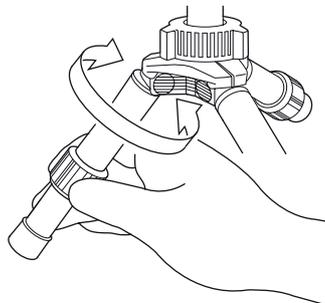
Ослабьте поворотный фиксатор вращением против часовой стрелки и вытяните ножку.
