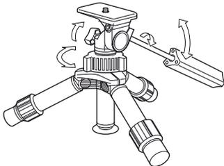
Ослабьте ручку и блокиратор горизонтального поворота. Поверните камеру в желаемое положение. Затяните снова ручку и блокиратор.
