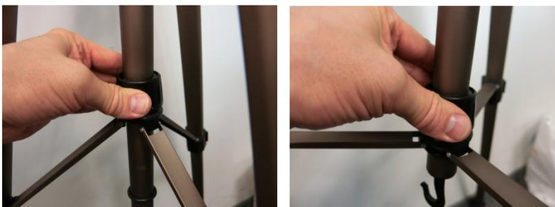
4. Отрегулируйте штатив по высоте – если это необходимо, поднимите центральную колонну с помощью реечного механизма- для этого освободите сначала фиксатор реечного механизма поворотом по часовой стрелке, потом покрутите ручку реечного механизма для подъема головки на нужную высоту и зафиксируйте головку на нужной высоте поворотом фиксатора против часовой стрелки.
