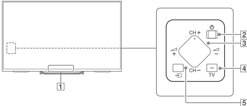
**[1] Датчик дистанционного управления\*<sup>1</sup> / светочувствительный датчик\*<sup>1</sup> / светодиодный индикатор / передатчик Sync 3D-сигнала\*<sup>1</sup>**
