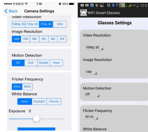
7.7 Нажав на кнопку Glasses Settings вы откроете меню управления настройками камеры. Здесь устанавливаются параметры съемки. ПРИМЕЧАНИЕ: Режим "MOTION DETECTION" (детектор движения) НЕ АКТУАЛЕН для данного устройства.
