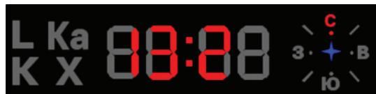
Значение напряжения батареи отображается на семисегментном индикаторе в течение 3 секунд, затем устройство переходит в нормальный рабочий режим.
