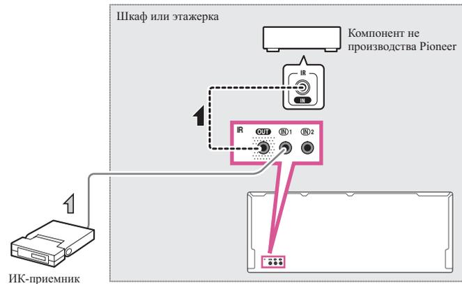
**2** Подключите гнездо IR IN другого компонента к гнезду IR OUT на задней панели данного ресивера для его подключения к ИК-приемнику.
