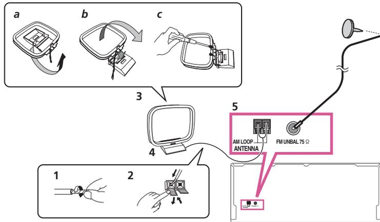
**1 Снимите предохранительные щитки с контактов антенны AM.**
