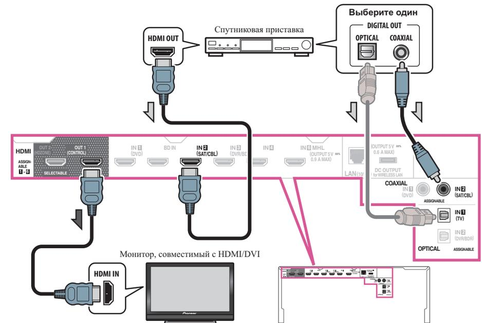
— При использовании цифрового аудиокабеля или (аналогового) аудиокабеля RCA потребуется указать ресиверу, к какому его цифровому входу подключена приставка (см. [Меню Input Setup](#) на [стр. 41](#)).
