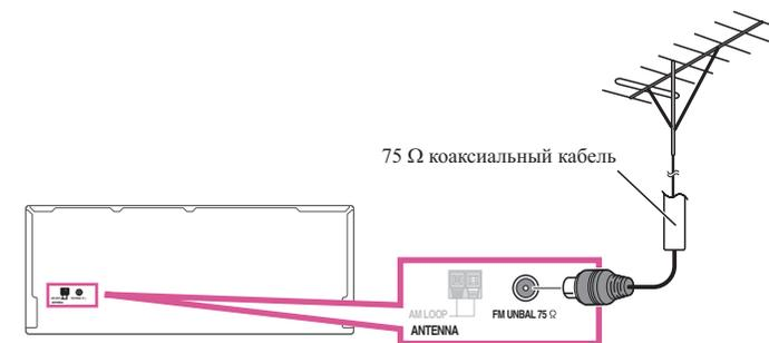
Для улучшения приема в диапазоне AM подключите к разъемам AM LOOP провод длиной от 5 м до 6 м с виниловой изоляцией, не отсоединяя прилагаемую рамочную антенну AM. Для наилучшего качества приема подвесьте ее горизонтально снаружи.
