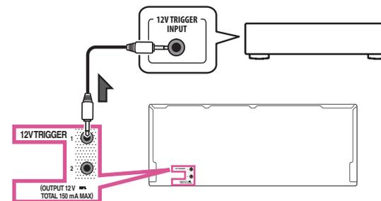
● **Подключите разъем 12 V TRIGGER данного ресивера к 12 В триггеру другого компонента.**
