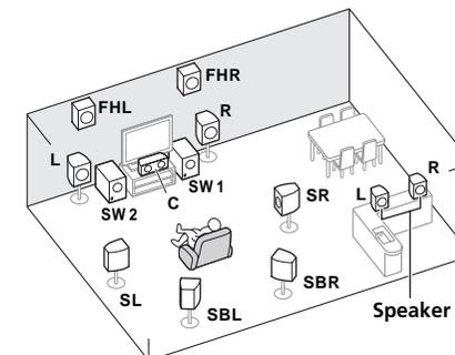
Данные подключения позволяют одновременно прослушивать 5,2-канальное объемное звучание в основной зоне и стереофоническое воспроизведение того же источника от громкоговорителей В. Те-же самые подключения также позволяют воспроизводить 7,2-канальное объемное звучание в основной зоне, когда громкоговорители В не используются.
