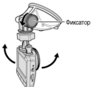
Для регулировки положения по вертикали, ослабьте фиксатор.
