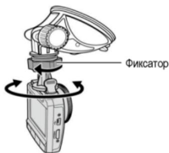
Для регулировки положения по горизонтали, ослабьте фиксатор.
