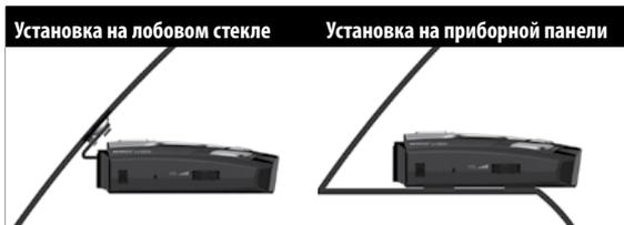
Необходимо обеспечить отсутствие препятствий перед объективом устройства, а также свободный обзор заднего стекла из местоположения линзы LaserEye для обнаружения с охватом 360°.
