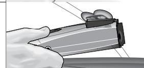
5. При необходимости наклоните кронштейн для регулировки угла, аккуратно нажав на кронштейн или потянув его на себя. ЗАПРЕЩАЕТСЯ прилагать усилие к детектору для наклона кронштейна.
