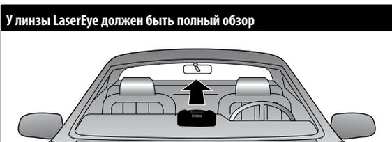
Сигналы радара и лазерных устройств проходят через стекло, но не проходят через другие материалы и предметы. Воспрепятствовать приему сигнала или ослабить его могут, в частности, следующие предметы:
