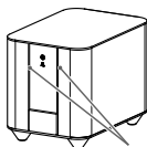
Orificiu de ventilație
