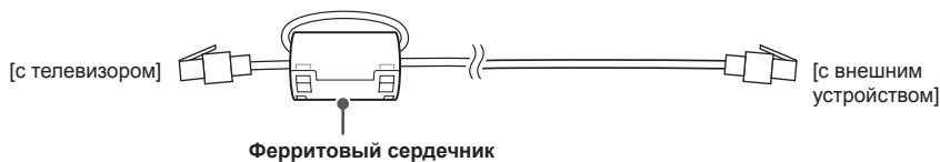
[Вид ферритового сердечника в разрезе]
