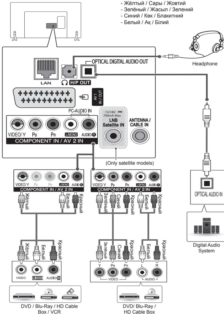
Digital Audio System: Цифровая аудиосистема / Цифрлық аудиожүйе / Цифрова аудіосистема
