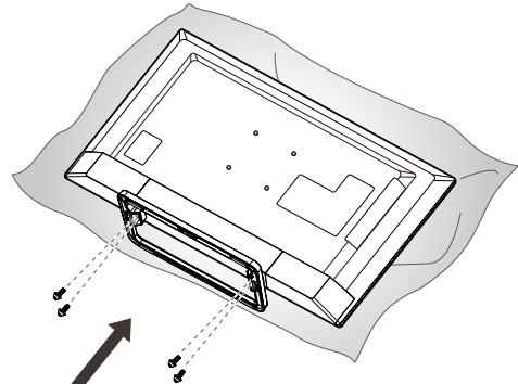
4 Надежно затяните сборочные винты отверткой.
