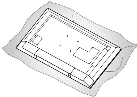
2 Вставьте крючок на основании в отверстие на нижней части телевизора.
