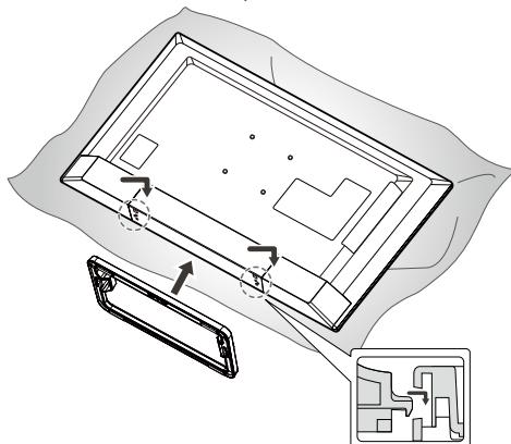
3 Тщательно закрепите основание на телевизоре сборочными винтами для основания.
