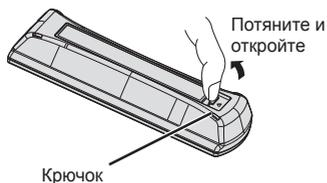
2 Вставьте две батарейки R6-AA (1,5 В) в соответствии с пометками полярности "+" и "-" внутри батарейного отсека и установите крышку батарейного отсека на место.
