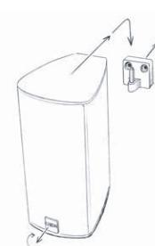
Предпочтительное место для центральной колонки - выше или ниже телевизора. Для увеличения угла распространения звука миницентр Canton оборудован стабилизатором. Прикрепите его к задней части корпуса как это показано на рис. 6. Настройвая стабилизатор, Вы можете отрегулировать его высоту и угол распространения звука из центральной колонки.
