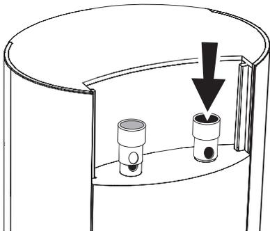
В. Вставьте неизолированный конец провода в отверстие
